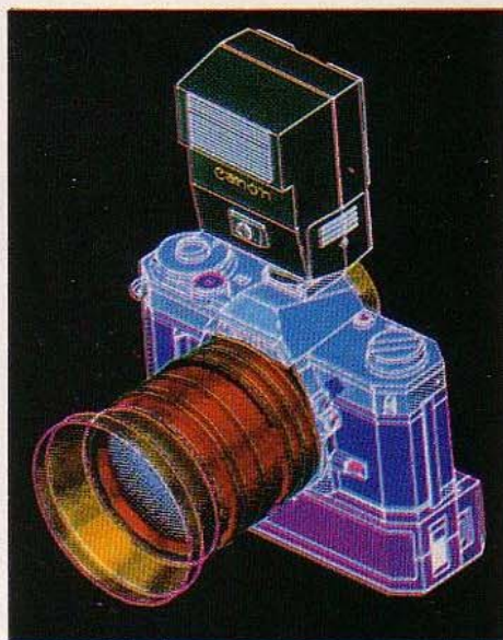
Maquette virtuelle réalisée pour Canon avec le logiciel DDM (tridimensionnel) de Calma (700 000 instructions Fortran).
