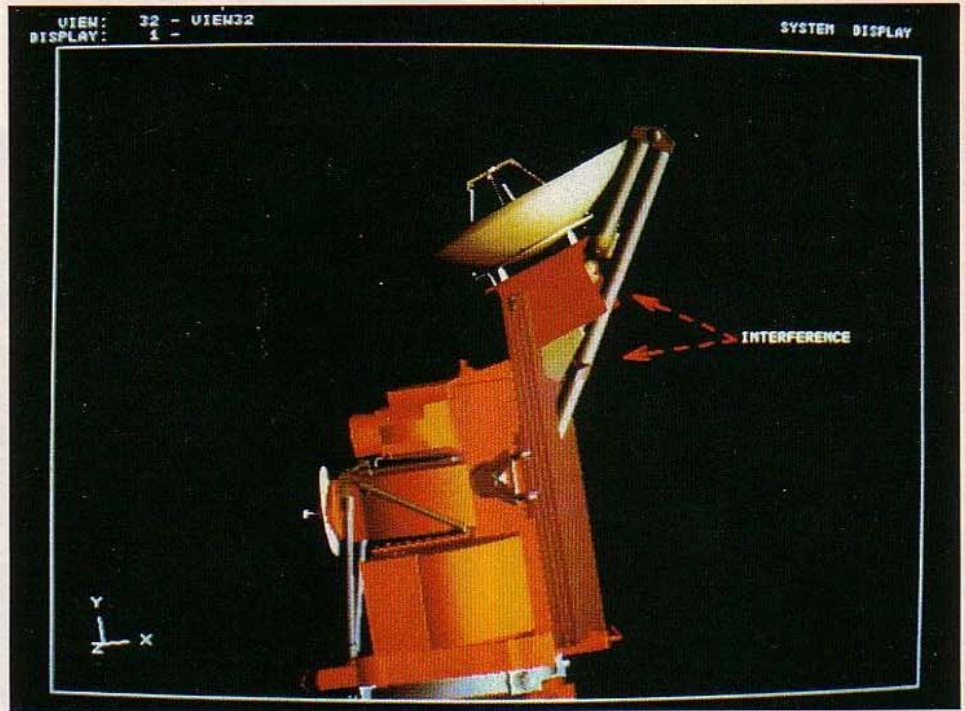
Détection des interférences entre les panneaux de captage solaire et le corps d'un satellite. (Logiciel Géomod de Calma).
