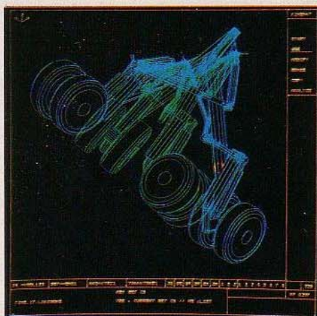
Représentation filaire d'un train d'atterrissage et étude du mouvement avec le logiciel Catia.
