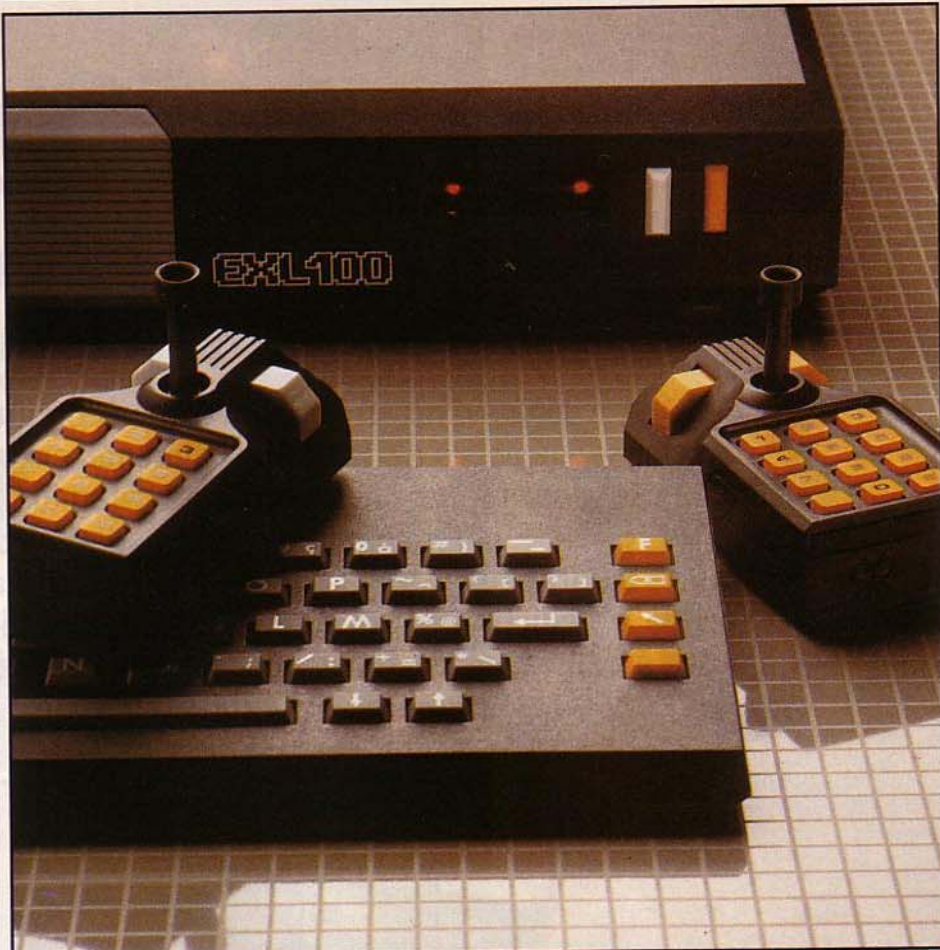
Le clavier et les manettes de jeu dirigés vers l'émetteur-récepteur infrarouge (les deux points lumineux). Au-dessus de la marque, la fente d'introduction des cartouches de mémoire morte.
