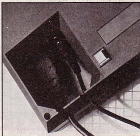
Plus de débranchements intempestifs. Les cordons d'alimentation et du moniteur sont prisonniers du boîtier.
