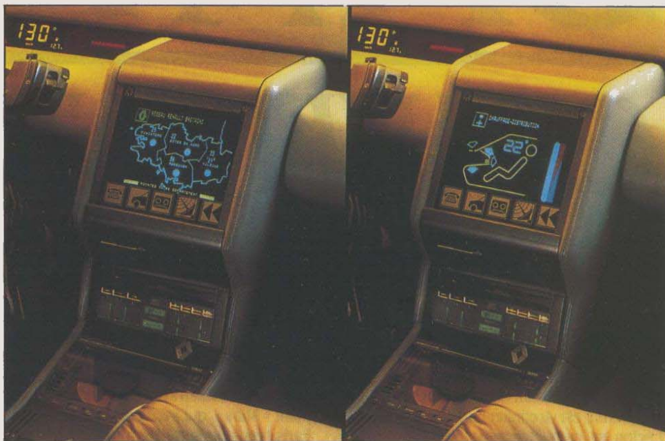
Le système Dialog-Atlas de Renault : aide à la circulation, mais également contrôle total sur le fonctionnement du véhicule (consommation moyenne, usure des freins, etc.).
