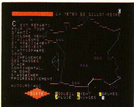
La météo exploite à fond les possibilités graphiques limitées de la norme française de vidéotex Antiope. L'article est l'un des rares qui occupent deux pages-écran.
