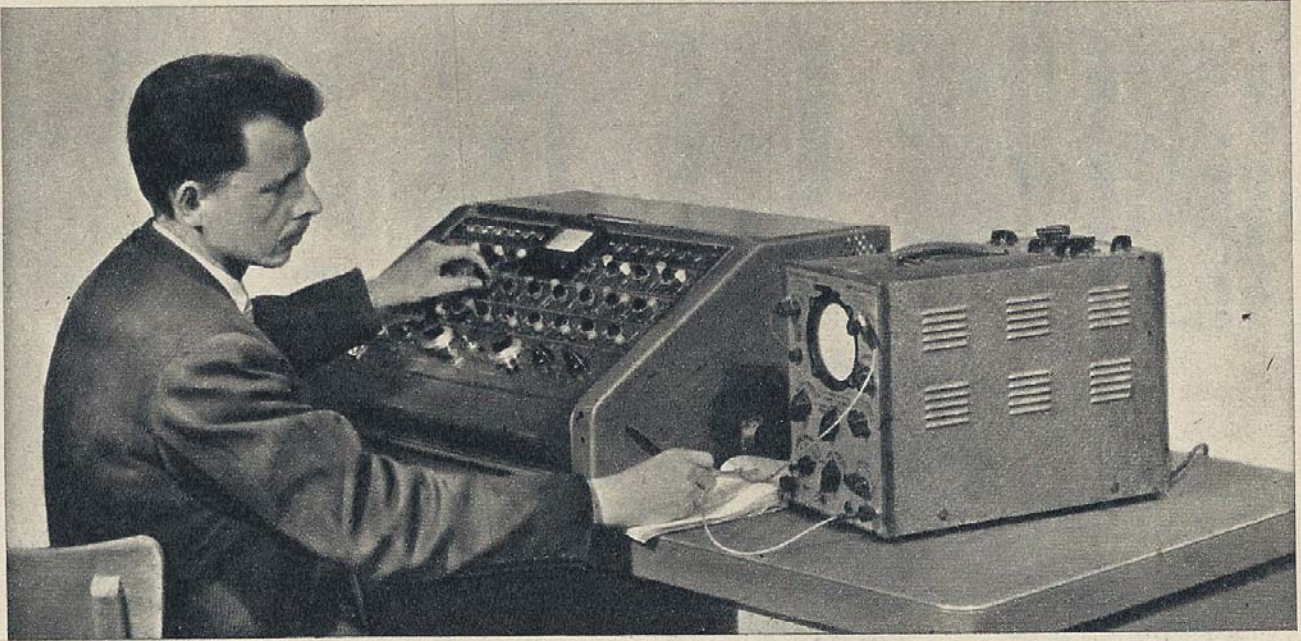
Calculateur analogique répétitif de la SEA. D'un encombrement très réduit et d'une faible consommation, grâce à son équipement de transistors, il permet de résoudre un grand nombre de problèmes scientifiques, techniques et autres, dont les solutions sont observées sur un oscillographe à tube rémanent.
