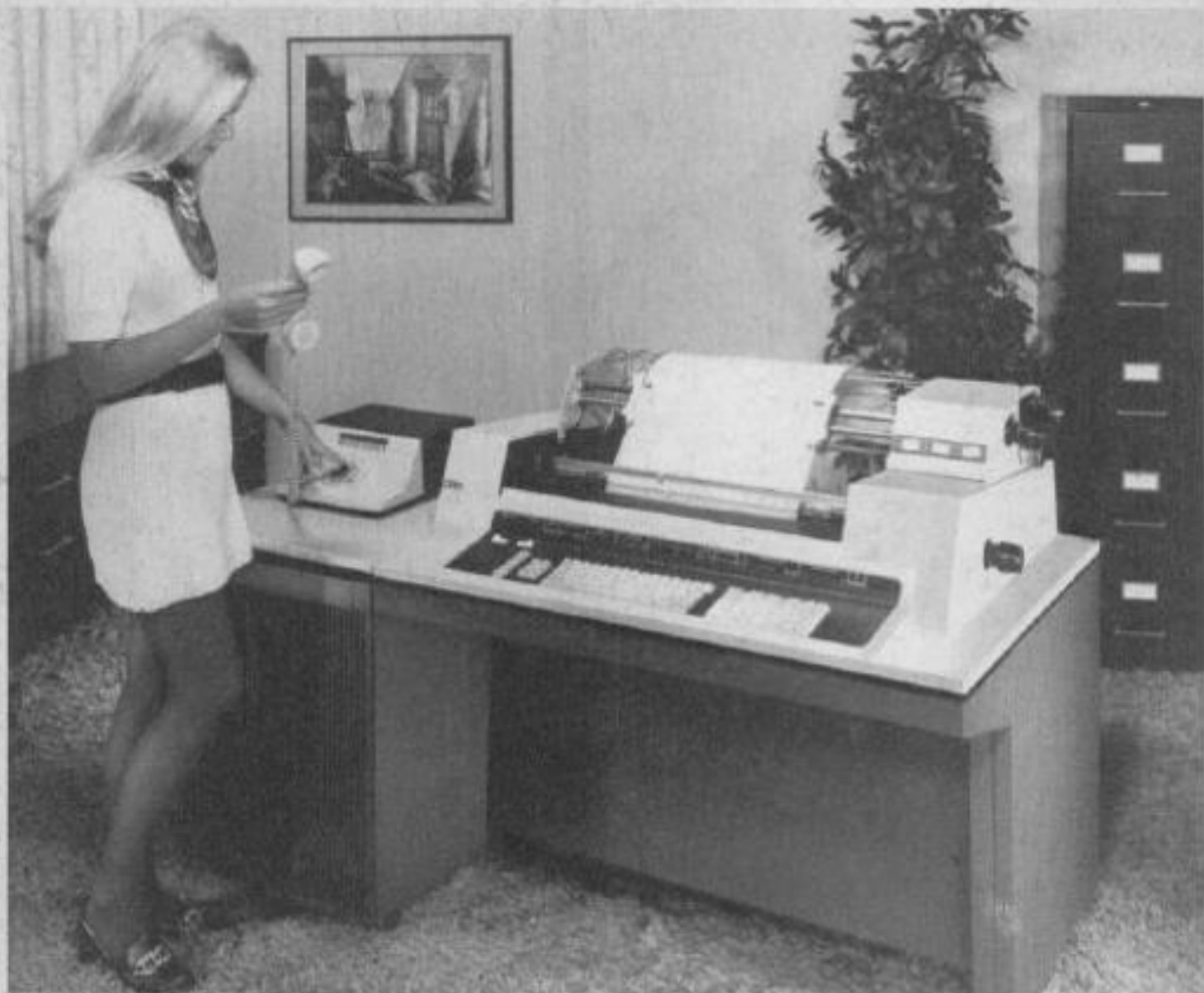
Cette machine de faible puissance (NCR 399) peut servir à la fois de terminal lourd pour un ordinateur plus puissant, et de calculateur local. Ce concept est de plus en plus répandu.
