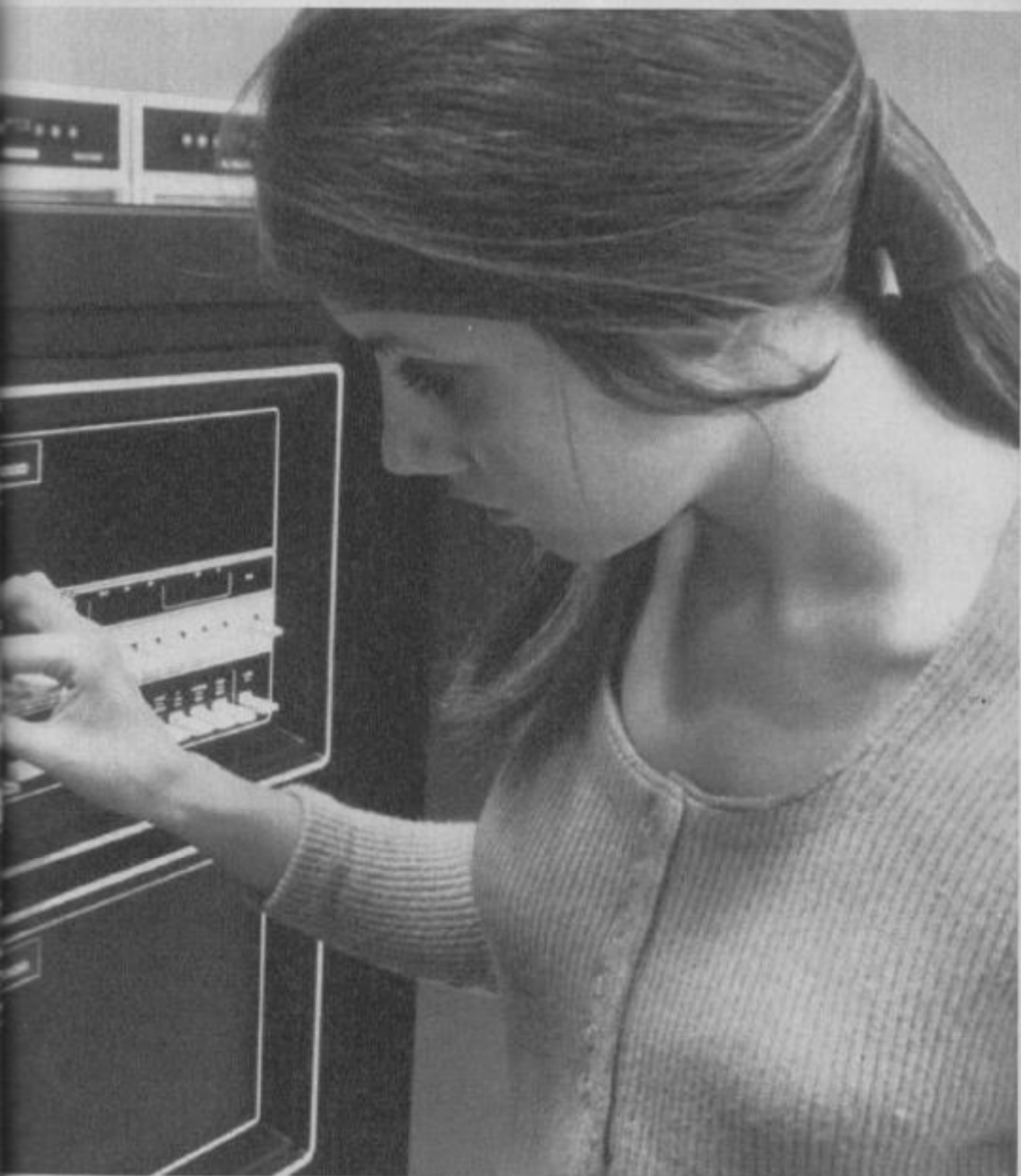
Le mini-ordinateur capable de gérer jusqu'à 120 lignes de communications avec divers terminaux à distance.
