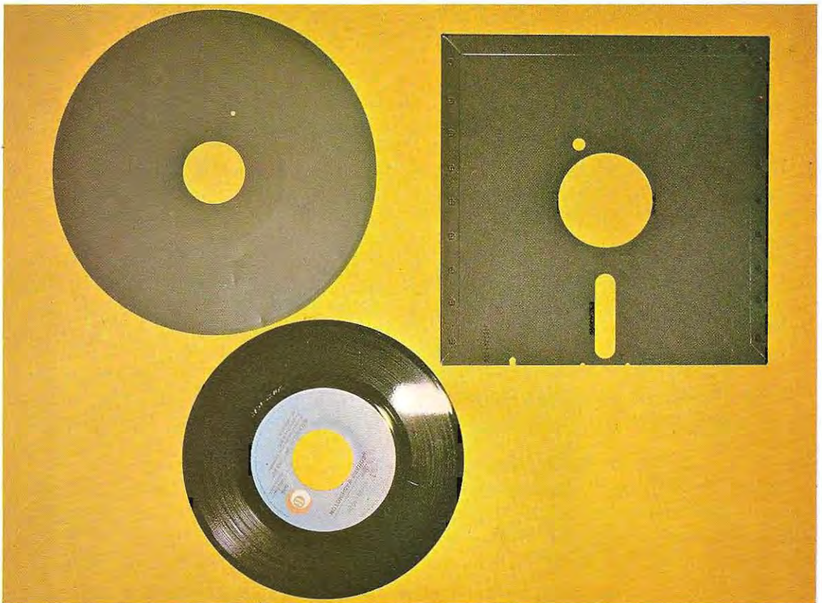
Une disquette (floppy) et un 45-tours ordinaire. Cette disquette 8"-DF-DD (8 pouces - double face - double densité) a une capacité d'environ 1 200 000 caractères.
