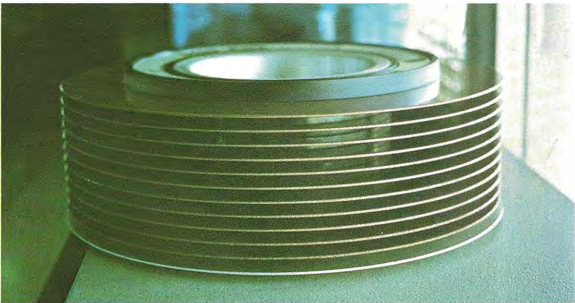
Le dispac constitue la mémoire de masse à accès direct des gros systèmes.
