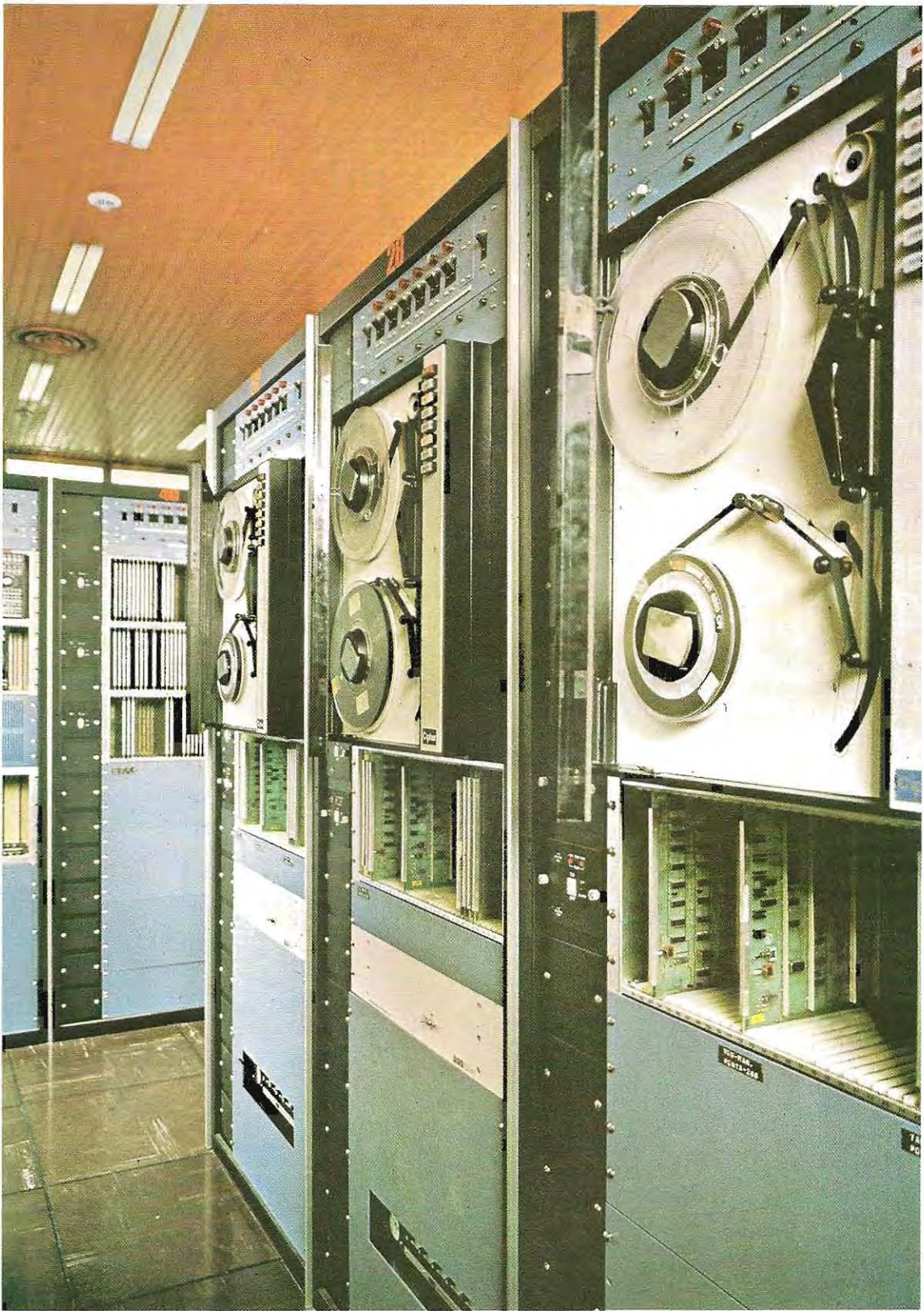
Ces dérouleurs de bande utilisés dans un centre de calcul nécessitent une intervention manuelle.
