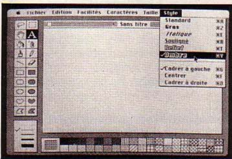
La gestion des diverses polices de caractères utilisées dans les textes est, elle aussi, confiée à la mémoire morte, qui fait 64 Ko.
