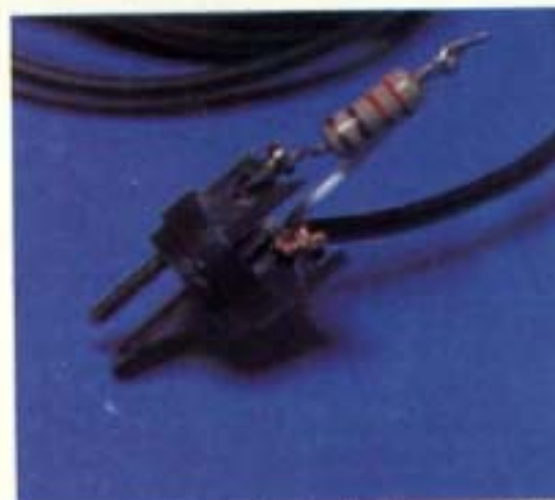
Au cas où vous choisiriez d'utiliser la prise « haut-parleur » de votre tourne-disque, il vous faudra insérer une résistance de protection afin de ne pas endommager l'étage de sortie de l'amplificateur de votre tourne-disque.
