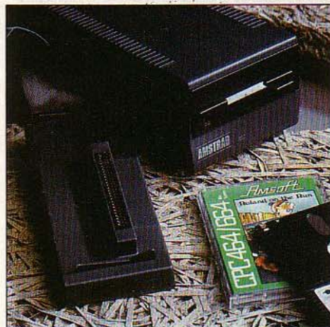
Le lecteur de disquettes, au format 3 pouces et son contrôleur.
