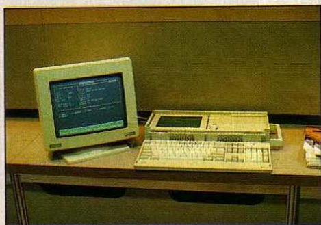
Sur un bureau, l'Amstrad PPC peut se connecter à un écran graphique, monochrome ou couleur.
