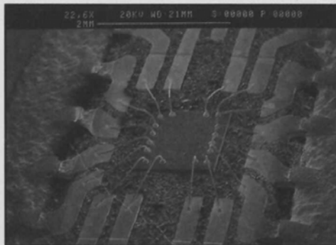
Le circuit-mémoire agrandi révèle les points de connexion intéressants.
